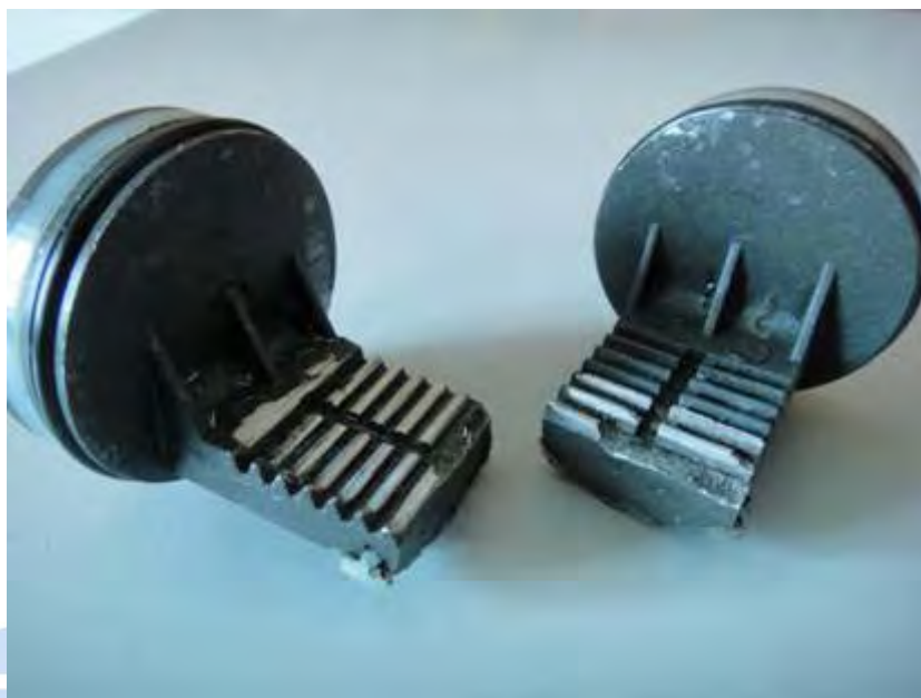
（图 3—齿轮齿条式执行器在应用中受损的直齿条现状图）
