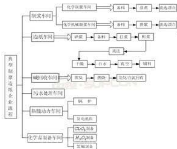
图1 大型造纸厂车间、工段分布体系结构图
